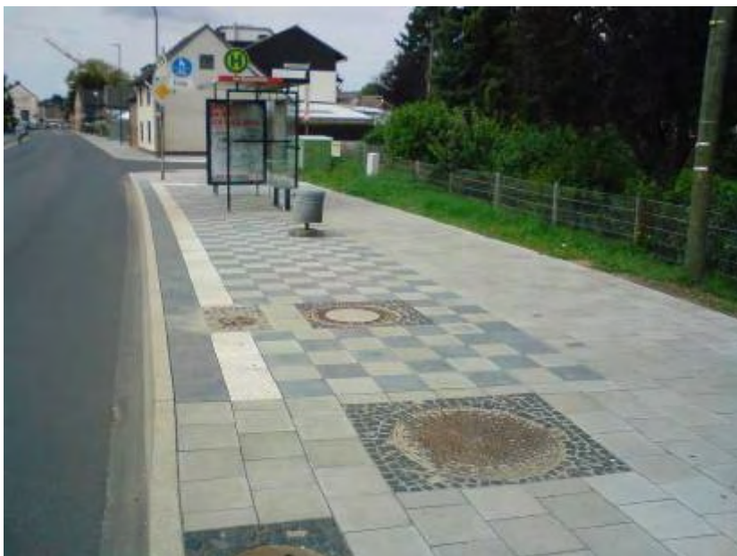
Bild 4: Hoher Farb- und Leuchtdichtekontrast durch Schachbrettmuster und Begleitstreifen an einer Haltestelle (Foto: Boenke)
