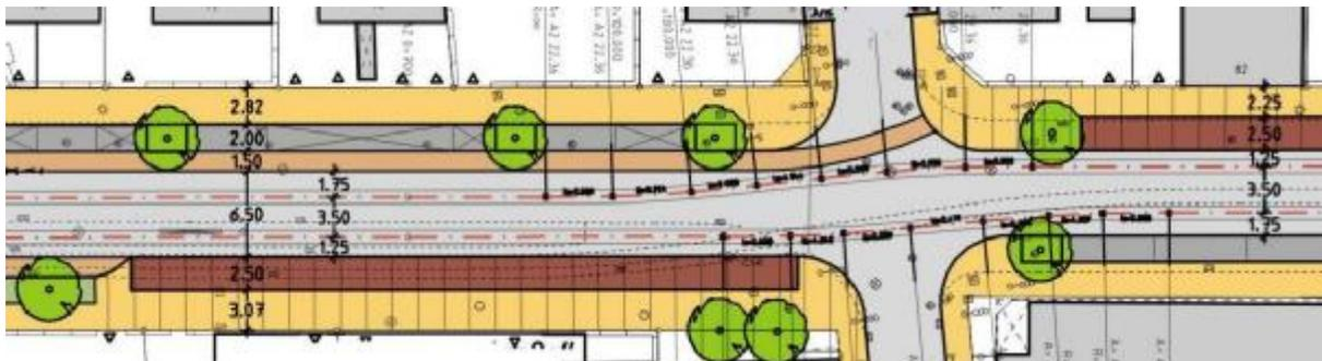
Abbildung 9: Unstetige Radverkehrsführung, fehlender Sicherheitsstreifen
