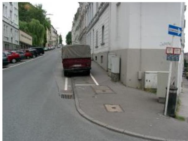
Abbildung 5: Einschränkung des Gehweges und unterdimensionierte Parkstände
