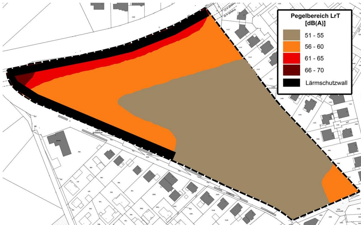
Abbildung 6: Lärmbelastung am Tag in den Außenbereichen der Stadt B mit aus Sicht der Autoren möglichen zwei Wällen [5]
